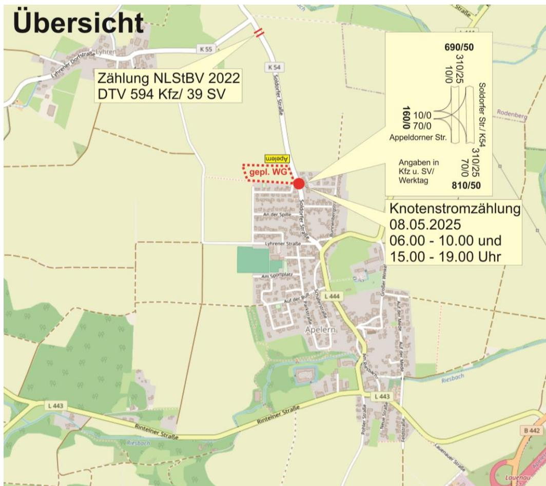
(8) Zur Ermittlung aktueller Verkehrsdaten wurde am Donnerstag, den 8.5.2025 in der Zeit von 6.00 bis 10.00 und 15.00 bis 19.00 Uhr alle Kfz an der Eimündung der Appeldorner Straße in die Soldorfer Straße K 54 mittels Videotechnik nach Fahrzeugart und Fahrtrichtung getrennt erfasst.
