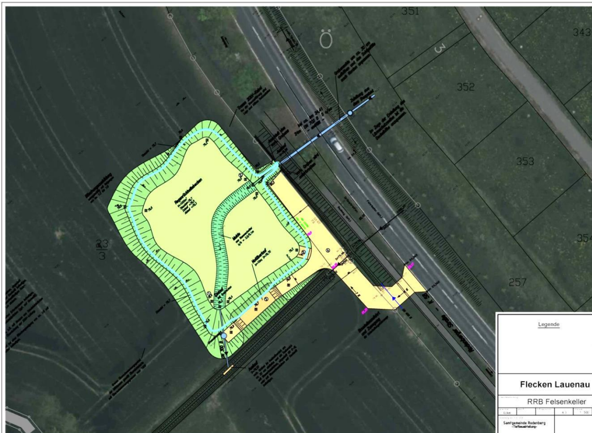
Abb.: Lageplan des Regenrückhaltebeckens
